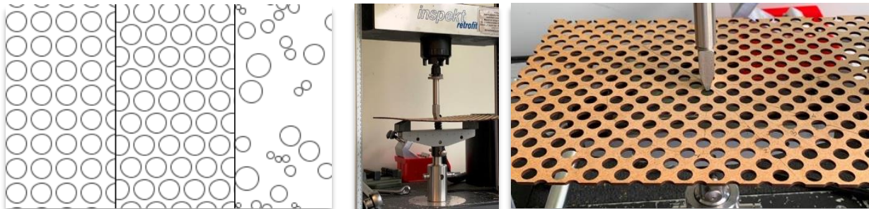
Fig. 1 : À gauche : trois arrangements spatiaux de disques aux propriétés différentes (deux arrangements « réguliers » et un arrangement « irrégulier »). Au centre et à droite : test mécanique de flexion 3 points sur une plaque de bois MDF allégée par des trous circulaires.
